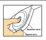
Откройте круглую крышку держателя ленты. Для этого надавите большим пальцем в центр верхней части. Затем откройте нижнюю прямоугольную крышку вдоль инструмента.
