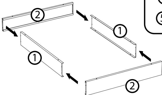
Сборка всех ярусов клумбы производится по одному типу. При сборке следует обратить внимания, что бы деталь 1 входила в паз детали 2. И загнутый торец находился с наружи детали 1,
